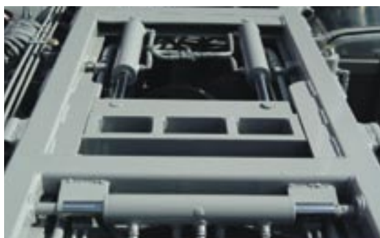
Här visas lås- och framdragarcylinder.
